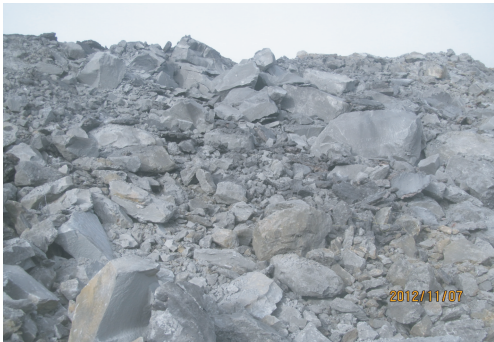
图 2 拉尺布孔爆破效果
