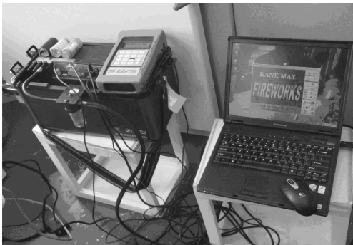
图 1 英国 KANE KM9106E 综合烟气分析仪
